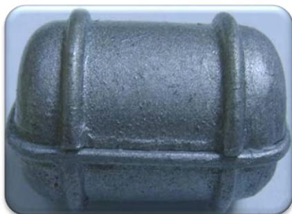
A Balsa salva-vidas fica em um casulo fechado e se infla com um dispositivo especial (ampola de CO<sub>2</sub>) para ser utilizada pelos náufragos.
